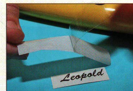
Obr. 22: Odstranění krycího papíru z přenosové fólie
