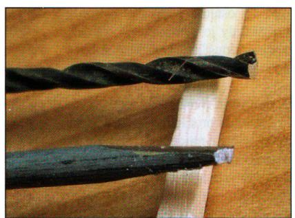
vrtekem vyřešíme i to, má-li být hloubka vrtané díry delší než délka běžného vrtáku. Kopinatý vrták zhotovený z drátu do jízdního kola je na fotografii.
