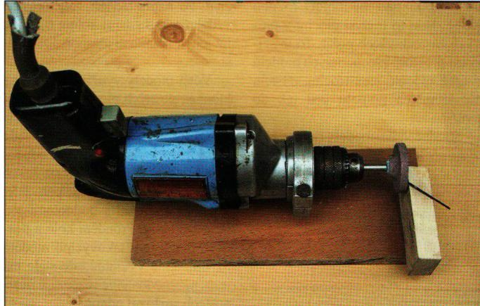
Po zakoupení brusky určené k broušení šroubovitých vrtáků o průměru od 3 do 10 mm mi zbyvalo dořešit broušení vrtáků malých průměrů. Když jsem se ptal svých známých, jak řeší broušení vrtáků, například o průměru 1 mm, odpověděli, že koupí nové. Proto jsem za pouhých dvacet minut zhotobil přípravek pro jejich broušení. Vše je zřejmé z fotografie a náčrtků.
