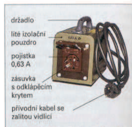
Obr. 2 Oddělovací transformátor pro ochranné oddělení sítě
