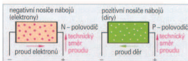
Obr. 2 Průtok proudu N- a P-polovodičem
