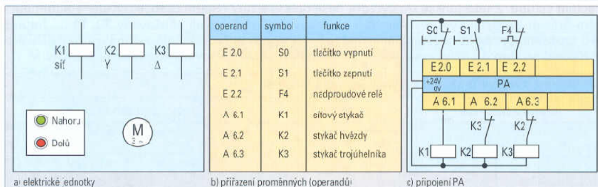
Obr. 1 Automatické přepínání hvězda – trojúhelník (příklad 6)
