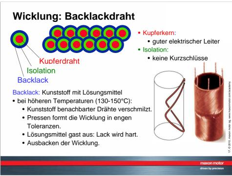
Frei tragende Wicklungen ohne Eisenkern werden aus einem so genannten **Backlackdraht** hergestellt. Der isolierte Kupferdraht ist aussen mit einer Backlackschicht überzogen. Während der Herstellung wird der Backlack benachbarter Drähte durch Temperatur und Druck miteinander verschmolzen.
