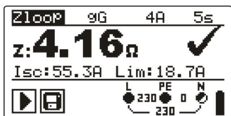
Obr. 5.10: Příklad výsledků měření skutečné impedance smyčky
