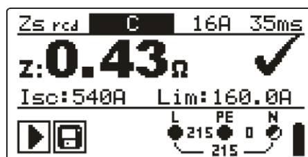
Obr. 5.10: Příklad výsledků měření skutečné impedance smyčky
