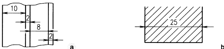
Obrázek č. 4.6, Přerušování čar při kótování
