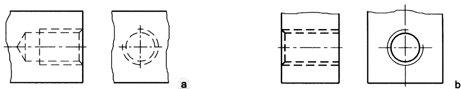
Obrázek č. 8.6, Zobrazování neviditelných závitů
