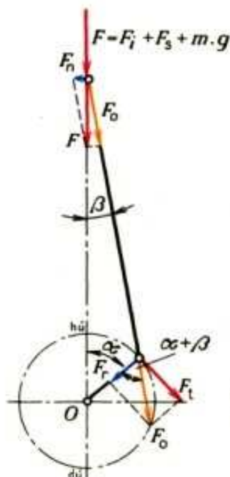
Obr. 19. Síly v klikovém mechanismu hú, dú – horní a dolní úvrať kliky
