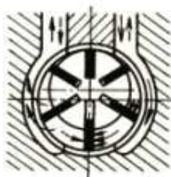
Obr. 136. Schéma a princip práce lamelového motoru se stejným výkonem a otáčením v obou směrech. Používá se u pneumatických utahováků apod.
