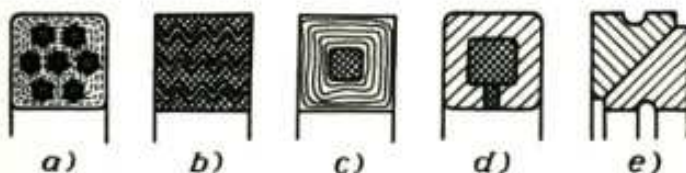
Obr. 30. Těsnivo ucpávek s kovovým těsnivem obsahuje vložky a obal z olova, mosazi nebo bronzu, též zinku, niklu, mědi nebo měkké oceli pro zmenšení opotřebení a zvýšení trvanlivosti
