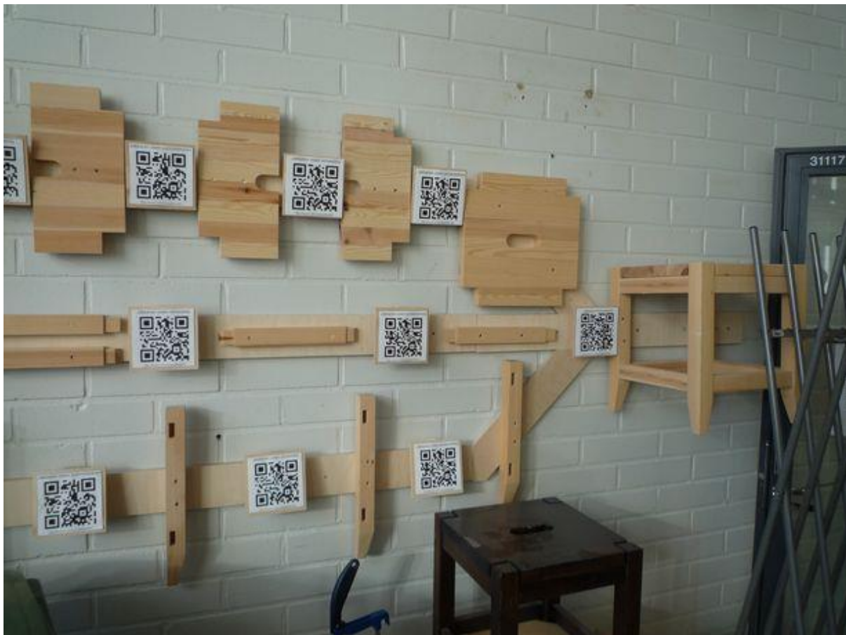
Zajímavý technologický postup výroby židle (s využitím QR kódu)
